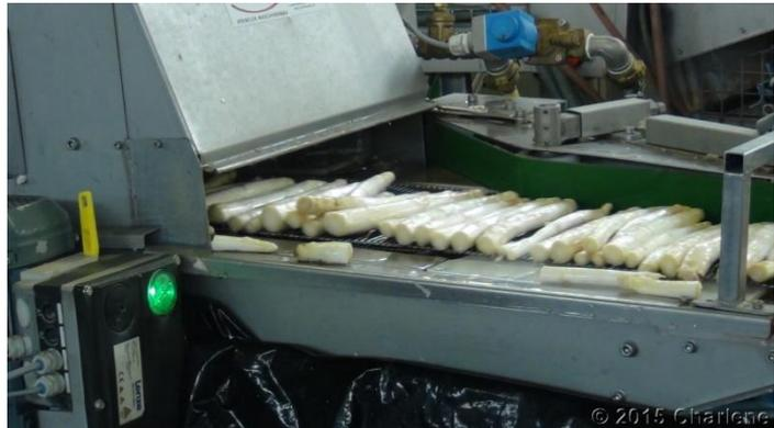
Die Spargel werden von der Maschine fotografiert und auf diese Weise sortiert.
