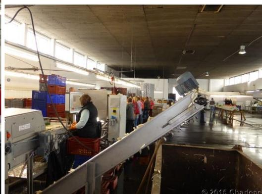
Sie laufen durch verschiedene Geräte, die sie nach Qualität und Klasse prüfen und dabei auf etwa 22 cm Länge schneiden. Die Abschnitte landen in einem Container.
